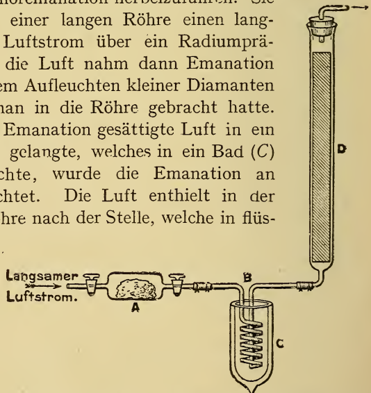
Anordnung von Soddy zur Demonstration der Kondensation der Radiumemanation durch flüssige Luft.
